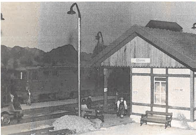
Bahnhof Uderns wurde aus einem Lutherer-Bausatz gefertigt. Die im Text beschriebenen Laternen sind hier deutlich zu sehen. Bemerkenswert der bei Schmalspurbahnen durchaus übliche „Prellbock“ in Form eines Sandhaufens.
